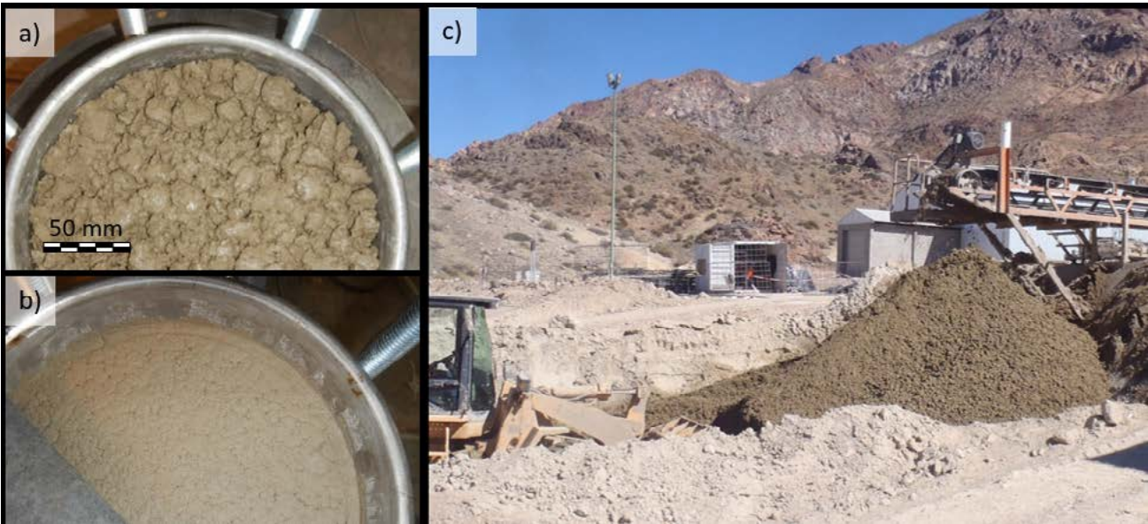
Figura 11. Tendencia de las colas t1 a agregarse formando grumos: a) antes del ensayo edométrico, b) después del ensayo edométrico y c) en stock-pile a la salida de la planta.
