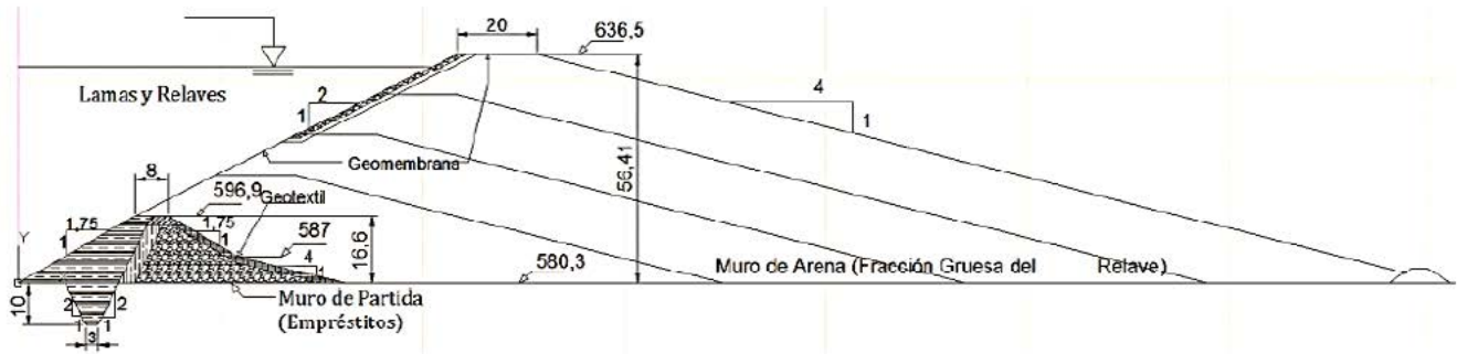
Figura 6. Sección Transversal Muro Principal Tranque Ovejera (Barrios, 2017).
