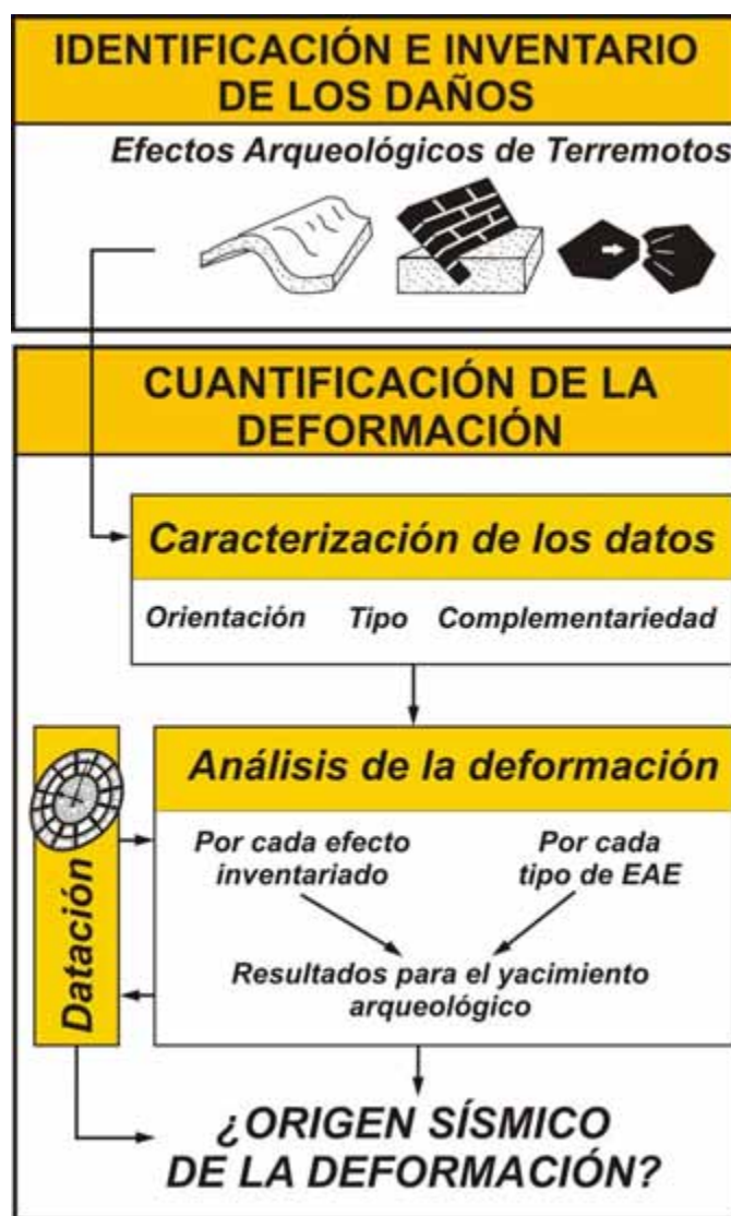
Figura 5. Esquema metodológico propuesto por Giner-Robles et al. (2009), para el análisis cuantitativo de las deformaciones presentes en estructuras de un yacimiento arqueológico (EAE) (Rodríguez Pascua et al. , 2011b).
