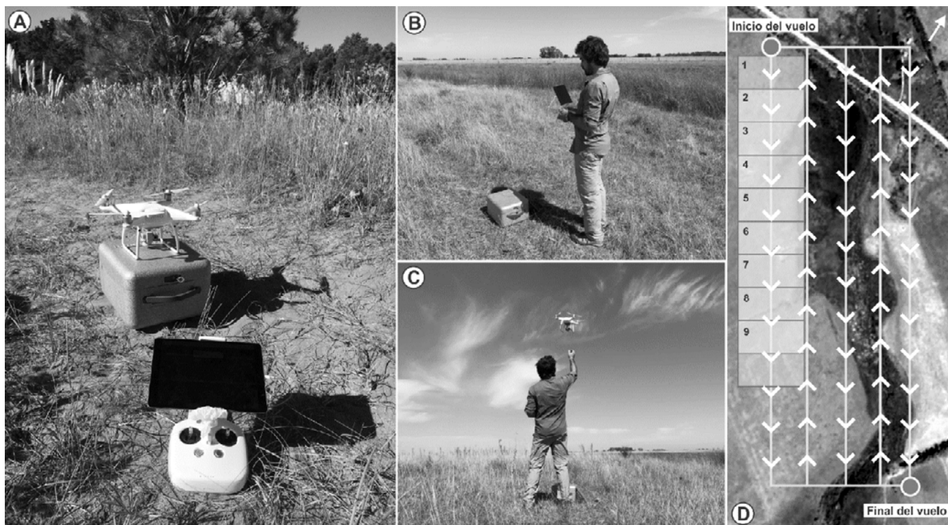
Figura 1. Relevamiento fotogramétrico. Preparación del equipo y geoposicionamiento (A), monitoreo del vuelo (B), final del vuelo (C) y grilla de vuelo (D).
