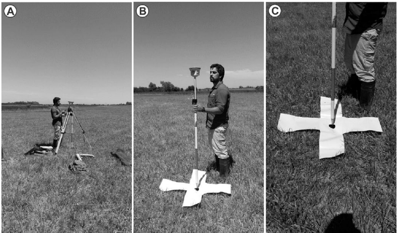
Figura 2. Acotamiento de los marcadores topográficos con equipo de GPS diferencial. Figure 2. Height measurement of topographic markers with differential GPS equipment.
