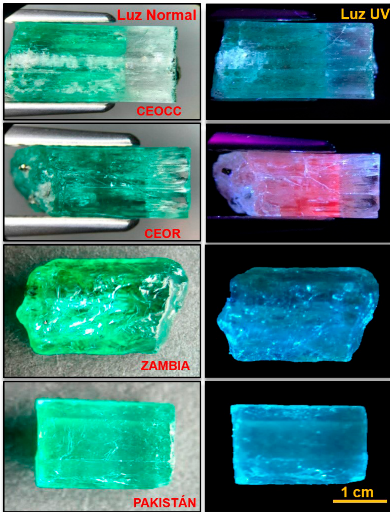
Figura 2. Respuesta a excitación con lámpara UV (365 nm) de las muestras de estudio.
