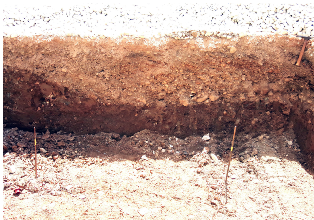
Figura 8. Facies de canal distribuidor en Residencial San Mateo. Grava canalizada con estratificación cruzada (arriba), y facies de grava roja desorganizada de ramblizo de talud (abajo). Martillo geológico (33 cm) para escala.
