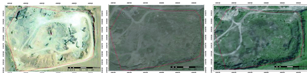
Figura 10. Ejemplo de análisis de cambios en la morfología del terreno en un socavón minero, municipio de Calimaya de izquierda a derecha: mina activa año 2006, mina en etapa de cierre año 2016 y mina abandonada en el año 2020.
