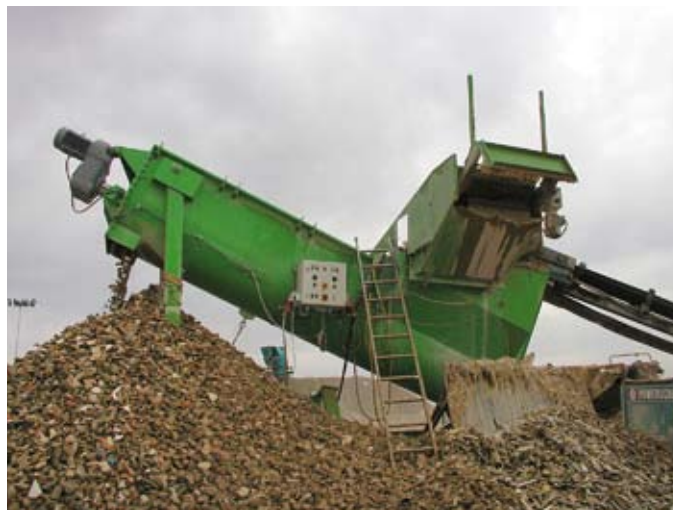
Figura 4. Separador hidráulico de tornillo sinfín. Figure 4. Worm gear hydraulic separator.
