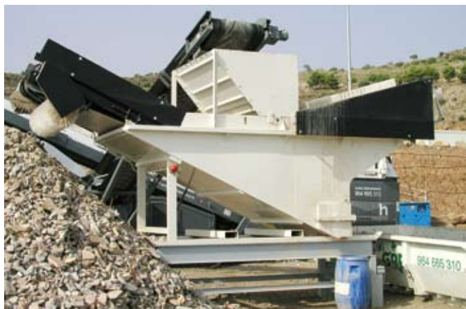
Figura 3. Separador hidráulico de transportador de banda. Figure 3. Belt conveyor hydraulic separator.
