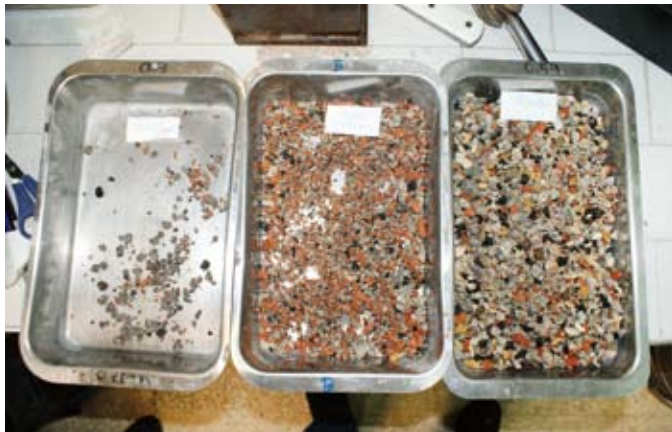
Figura 8. Separación en bandejas de los tres productos. A la izquierda los impropios (no pétreos), en el centro la fracción cerámica, y a la derecha la fracción de hormigón.
