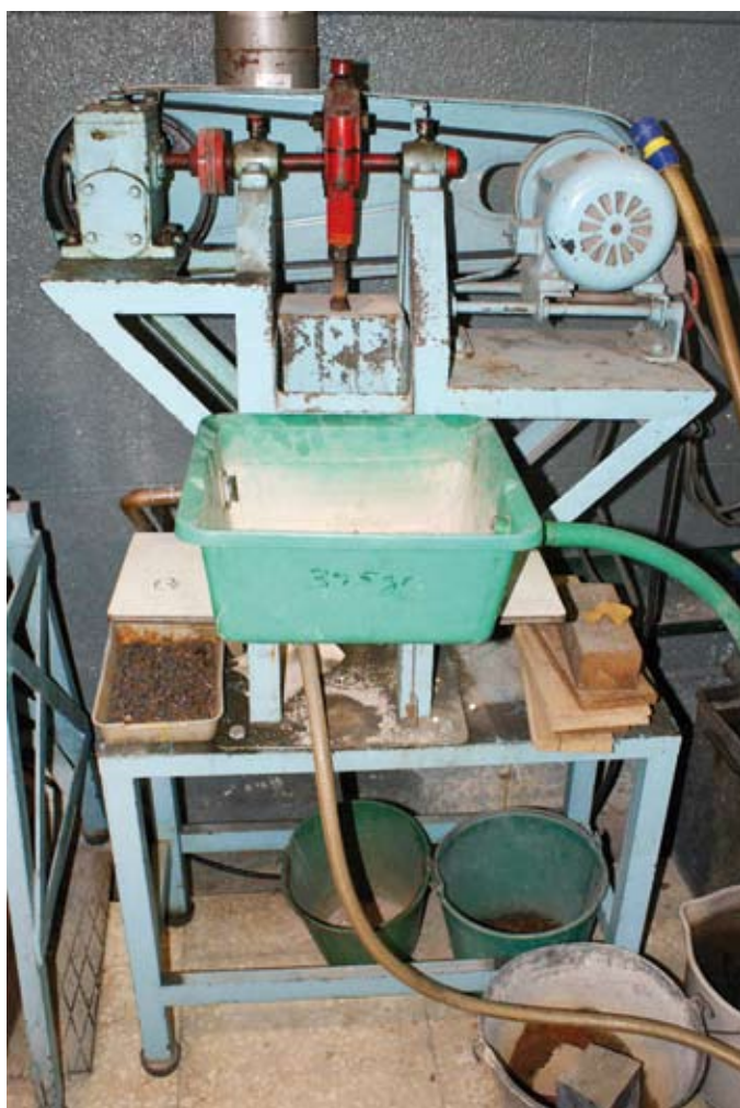
Figura 6. Fotografía del jig Harz del laboratorio de la ETSIM. Figure 6. Photograph of a Harz jig in the ETSIM laboratory.
