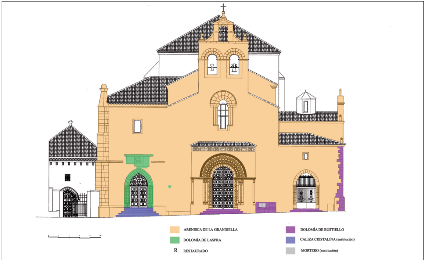
Figura 4. Cartografía litológica sobre el alzado de la fachada Figure 4. Lithological map projected onto the elevation of the façade
