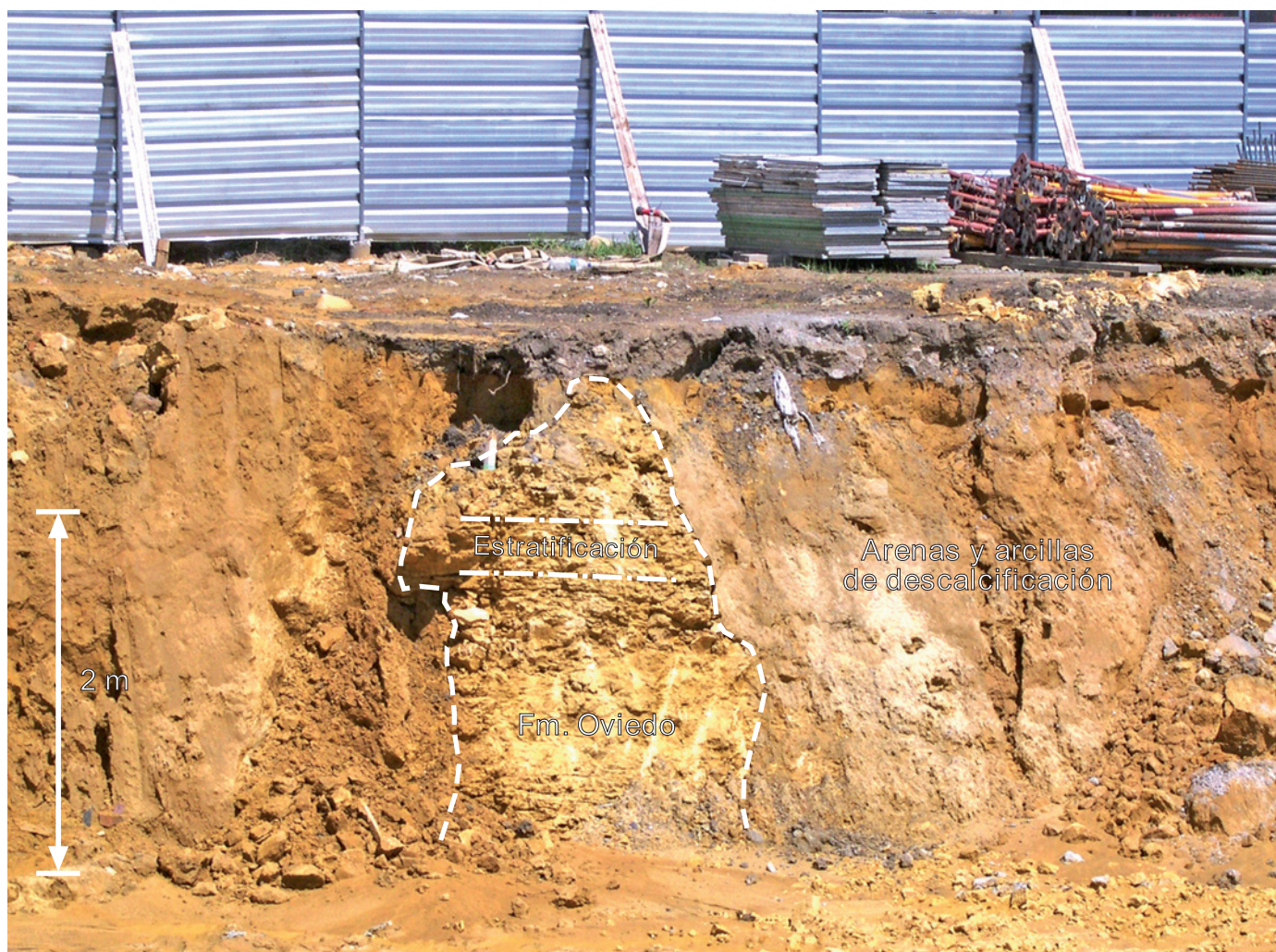
Figura 3. Descalcificación de las calizas arenosas de la Formación Oviedo en Colloto (término municipal de Oviedo). Figure 3. Decalcification of sandy limestone of the Oviedo Formation in Colloto (municipality of Oviedo).
