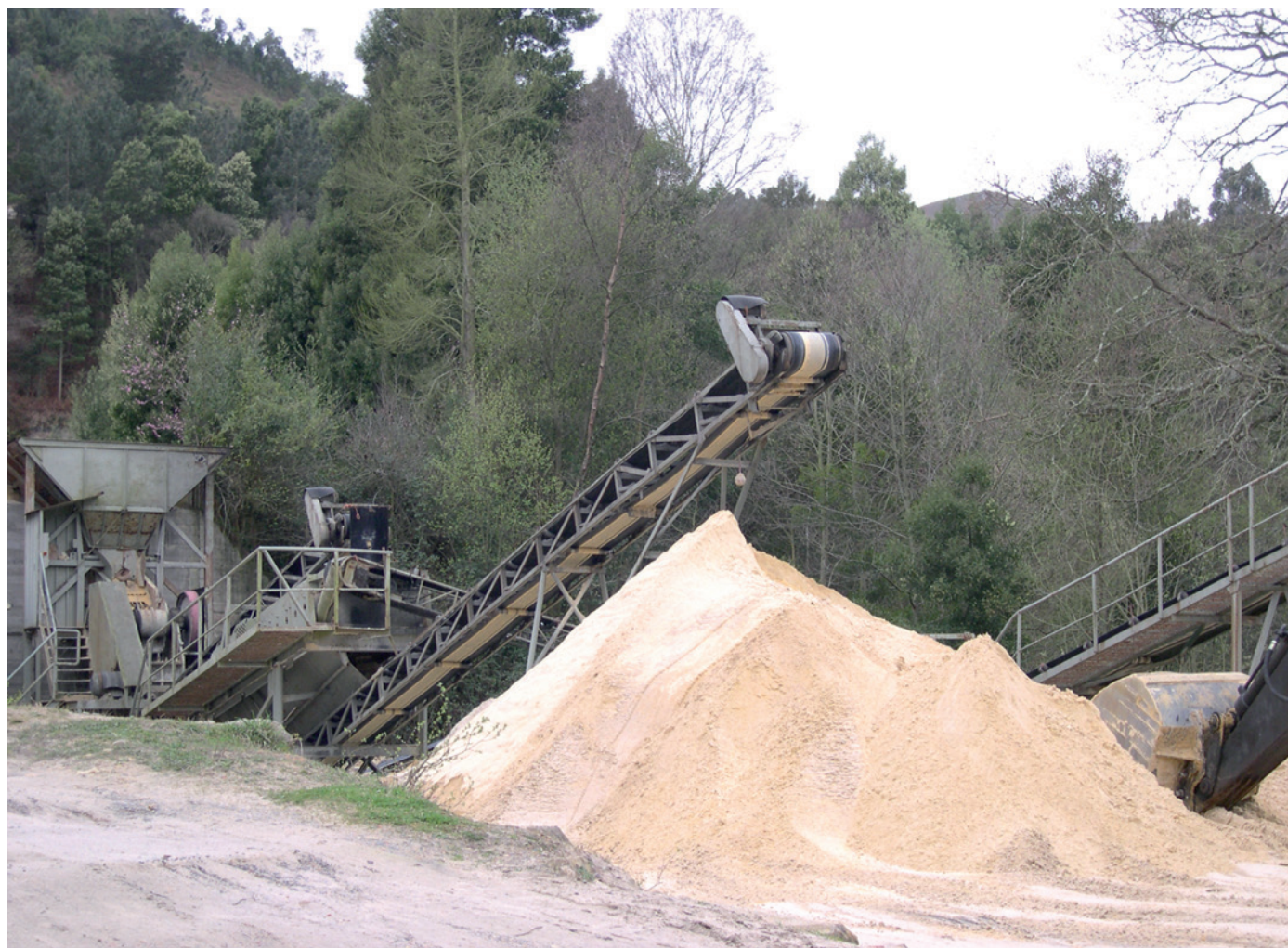
Figura 7. Aspecto de las arenas explotadas en las proximidades de Tezangos (Ribadesella), procedentes de la alteración de las cuarcitas de la Formación Barrios, tras ser sometidas a una ligera molienda.
