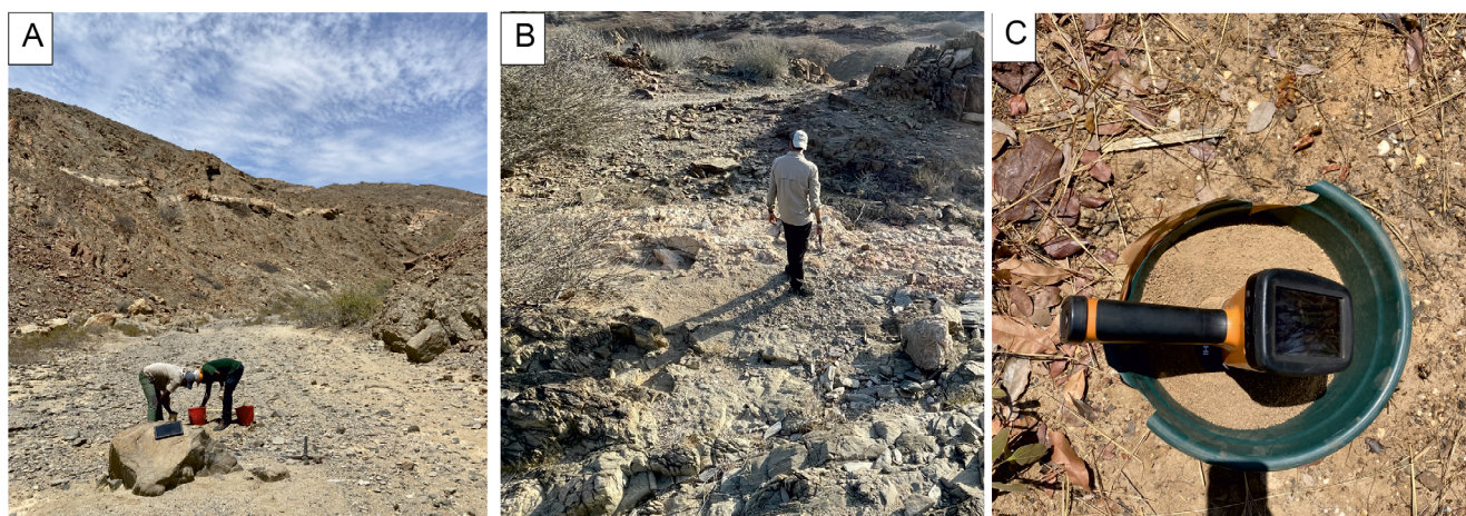
Figura 4. Fotografías de los trabajos de campo. A) Toma de muestras en sedimentos de corriente. B) Suelos residuales en la zona de las pegmatitas de Giraúl. C) Ejemplo de las mediciones realizadas con los analizadores portátiles de fluorescencia de rayos X en la zona de trabajo.
